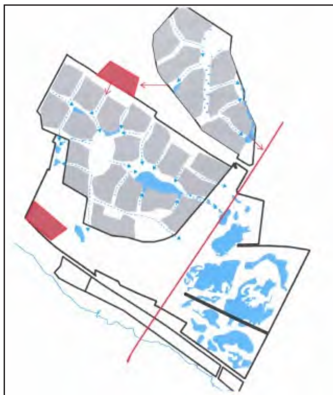
Figur 3.6.1: Illustration af princippet i LAR-systemet. Kilde: Orbicon, 19.11.2013.
