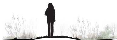
Grussti med opbygning på risknipper / 1,5 m
